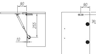
Схема монтажа крепежных планок газлифта на Боковину корпуса и Фасад. Более точная схема для определенного типа газлифта изображена на его упаковке.
